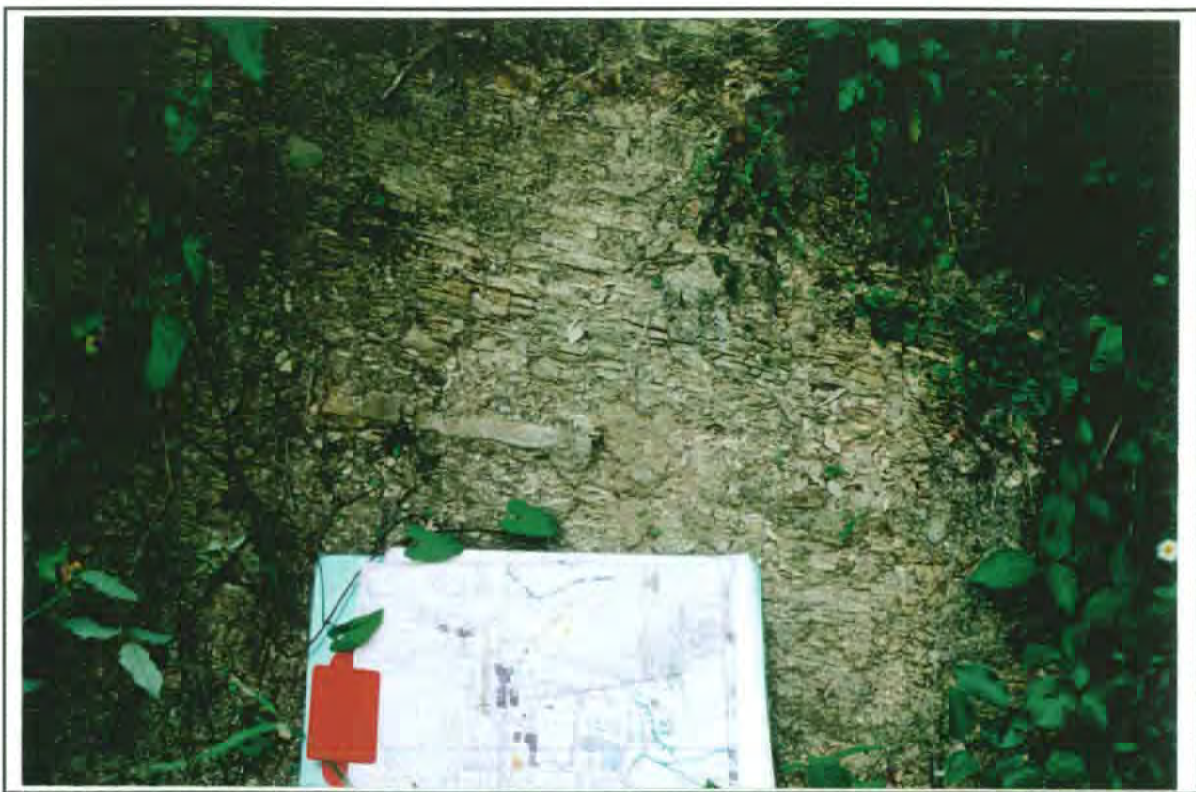
Foto 13. Affioramento del substrato roccioso, Flysch marnoso-arenaceo. Sono riconoscibili i sottili straterelli arenacei alternati alle marne argillose fogliettate prevalenti.
