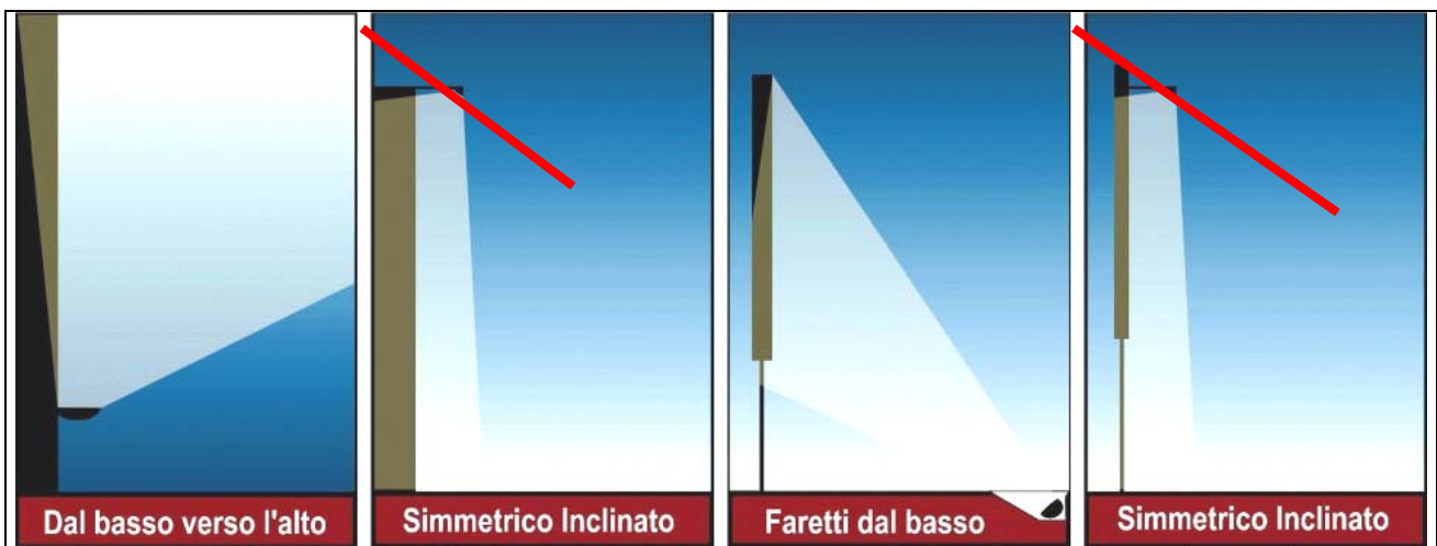
Figura 2.16 – Installazioni non conformi alla L.R. 17/00 e s.m.i. Nella rappresentazione grafica sovrastante, partendo da sinistra, l’illuminazione dal basso non è consentita se non per illuminazione di manufatti storici ed artistici ma mantenendo il fascio all’interno della sagoma dello stesso; nella seconda l’illuminazione dell’apparecchio inclinato va oltre l’edificio in quanto il piano passante per il vetro del proiettore inclinato non viene intercettato dalla parete. Nella terza e quarta immagine l’illuminazione del cartellone non è corretta in quanto l’unica illuminazione consentita sarebbe quella con proiettore orizzontale dall’alto verso il basso. (Cortesia CieloBuio)
